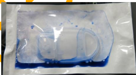
图 1 注射法试验图示
